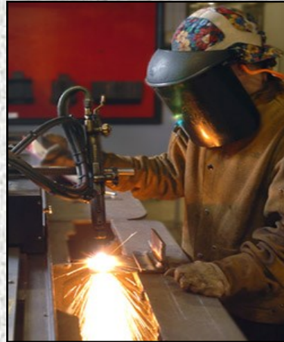
Neurria eginiko pieza-prestaketa, eskuzko oxiebakia erabiz, karbono altzairu profil eta xaflakin.
